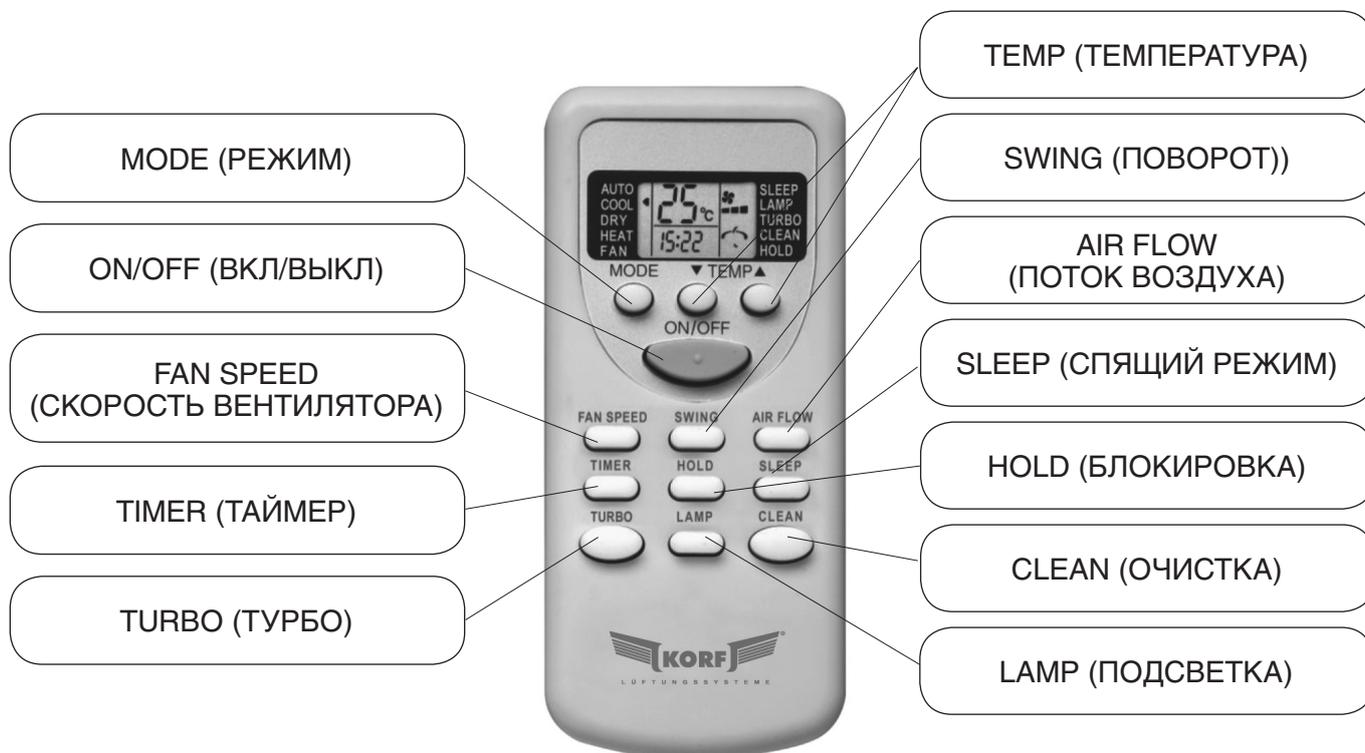
Кнопка РЕЖИМ (MODE) — служит для выбора различных режимов: автоматический, охлаждение, осушение, нагревание и вентиляция.
