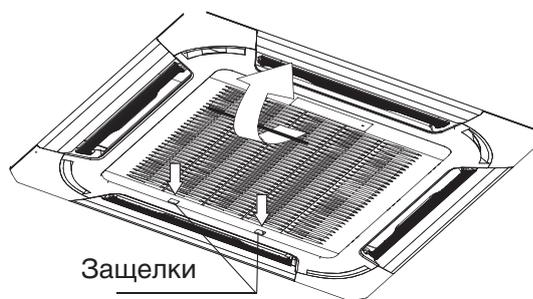
2. Отклоните ее на угол 45 градусов и снимите.
