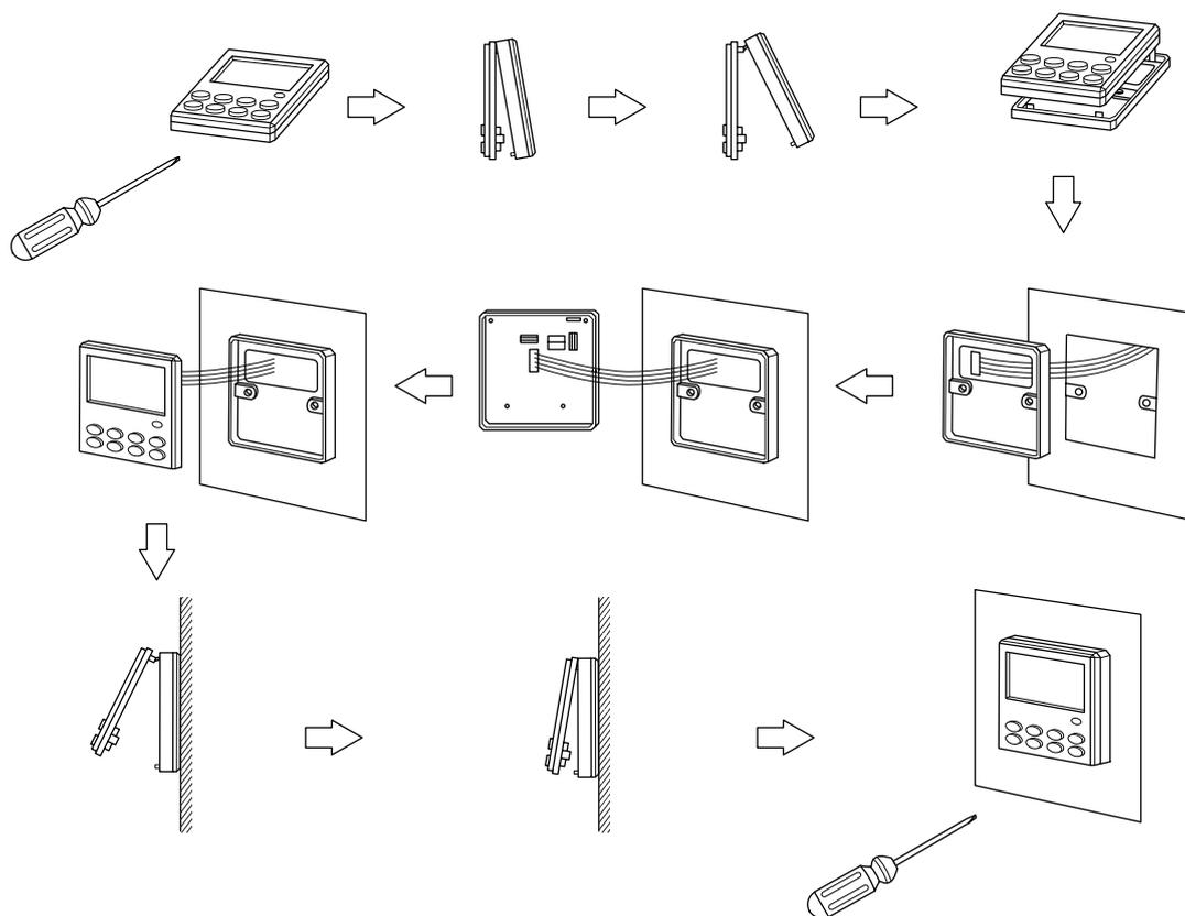
Во избежание электрических наводок при соединении внутреннего блока с пультом используйте экранированный кабель. Длина кабеля в любом случае не должна превышать 20 м.
