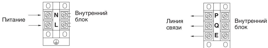
Питание внутренних блоков мультizonальных систем может быть подключено последовательно от блока к блоку (шлейфом) или отдельно.
